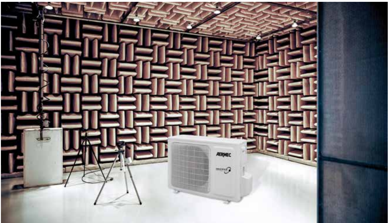
AERMEC Akustiktest im werkseigenen Akustiklabor
